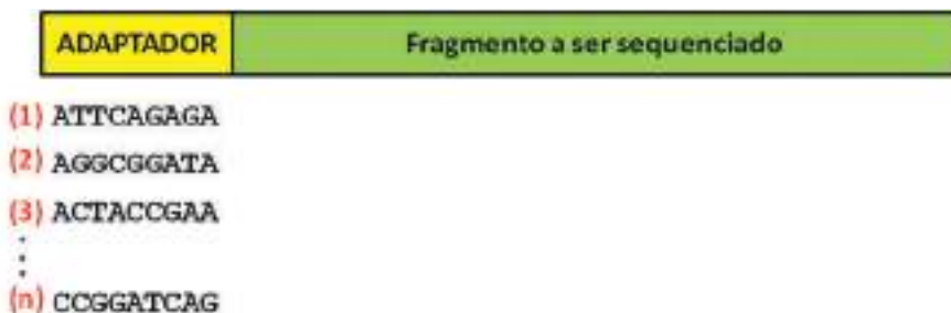
Figura 15. Sequenciamento através da técnica de multiplex. A adição de adaptadores distintos à extremidade dos fragmentos a serem sequenciados possibilita sequenciar várias amostras por linha.
