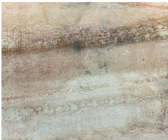
Figura 2: Detalhe de como as fibras da madeira se dispõem em várias direções, o que dificulta o lixamento da madeira de piquiá.
