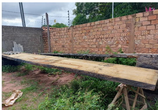
Figura 4: Tampo de mesa de piquiá em marcenaria. Espessura de 12cm. Comprimento de 4m.
